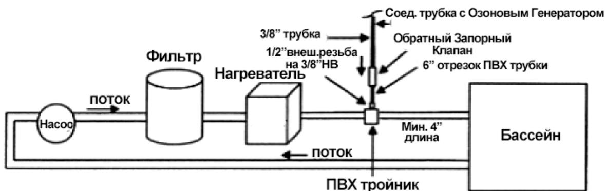
ПРИМЕЧАНИЕ: Должно быть минимальное расстояние 4 фута (1.2м) на возвратной цепи между точкой впрыска озоновых пузырьков и Бассейном. Если расстояние меньше 4 футов, то возвратная цепь может быть удлинена с помощью дополнительной гибкой петли.
