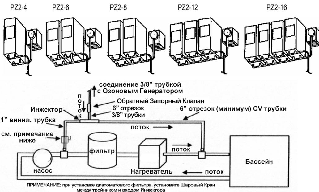
1. Непосредственно после Насоса и перед Фильтром установить переходник  $\frac{3}{4}$  дюйма на 1 дюйм для трубопровода, использующего подходящие соединители (не предоставлены).
