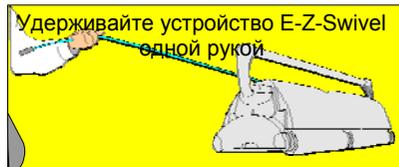
Расположите робот на полу, отсоедините штекер кабеля от трансформатора. Удерживая устройство в одной руке, отойдите от робота. Вытяните кабель на всю длину.
