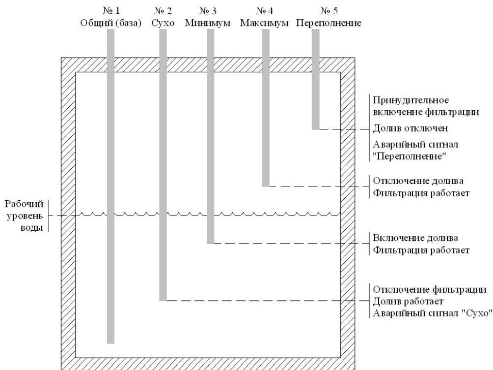
Для бассейна **скиммерного типа**, используются клеммы: №№ 1,2,3 в зависимости от заданного в пункте **6.4.6.9.** типа используемого датчика уровня воды.
