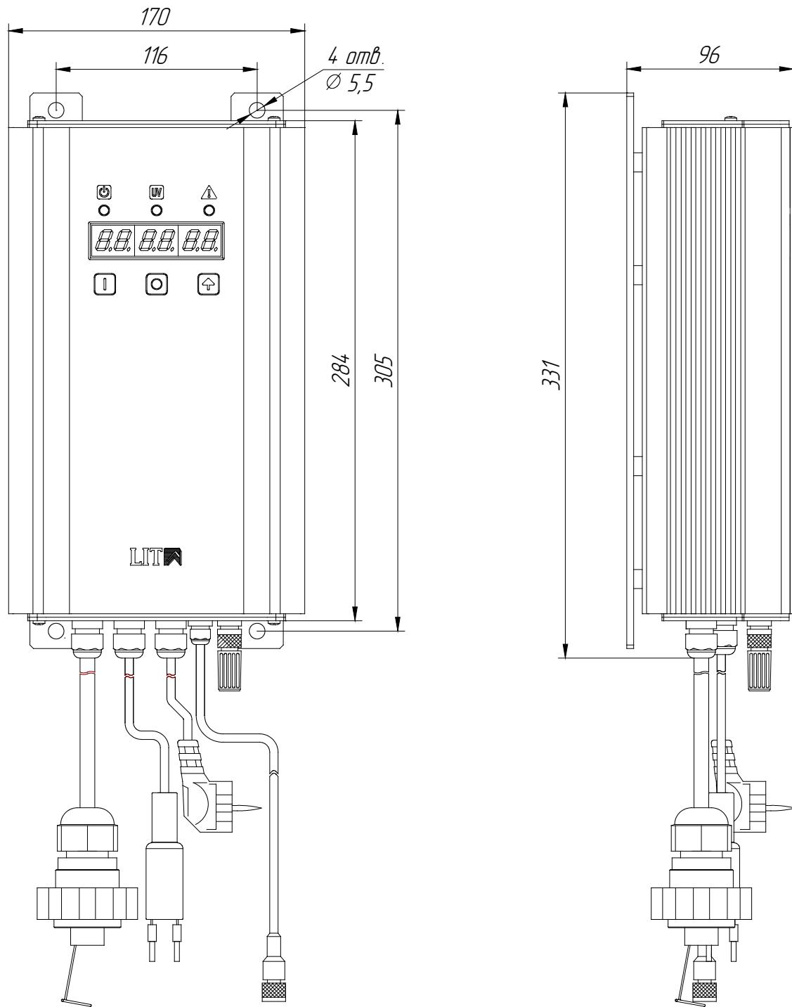
**6. ГАБАРИТНЫЙ ЧЕРТЕЖ КОМПЛЕКТА ПОДКЛЮЧЕНИЯ
