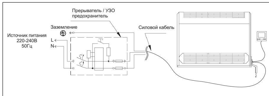
Примечание: осушение устройство должно иметь хорошее заземление.
