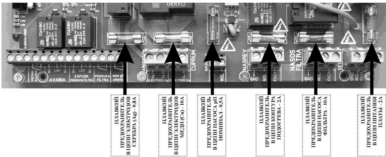
**!!!ВНИМАНИЕ!!!** Замена плавких предохранителей производится только при полностью обесточенном(отключенном от питающей электрической сети) электронном блоке управления.
