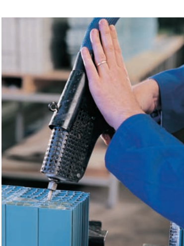
Производство. Монтаж стержней вручную.
