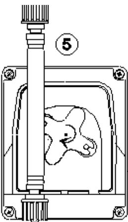
Вставить левый разъём в соответствующее гнездо и пропустить трубку под направляющей ручки. Вращать держатель датчика в направлении, указанном стрелкой, одновременно подводя трубку к голове насоса, до достижения правого разъёма
