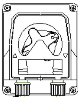
Сдвинуть крышку потянув вверх крепление слева
