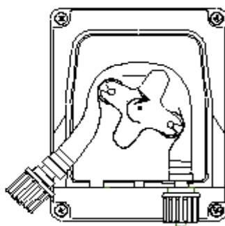
Разблокировать полностью разъём с левой стороны, удерживая его в натянутом положении, и повернуть ручку в направлении, указанном стрелкой, так, чтобы освободить трубку до соединения справа
