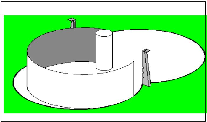
**Важное указание:** Чтобы стальная стенка временно держалась, уложите профили поручней на верхний край стальной стенки.
